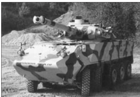
Швейцарская БМОГ «Пирана» со 105-мм гладкоствольной пушкой французской компании «Жиат»
