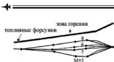
Рис. 13. Схема регулирования проточной части двигателя ПВРД WRR в зависимости от скорости (числа М) полета
