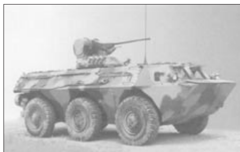
Китайская БМОП WZ-551 105 с 25-мм автоматической пушкой
