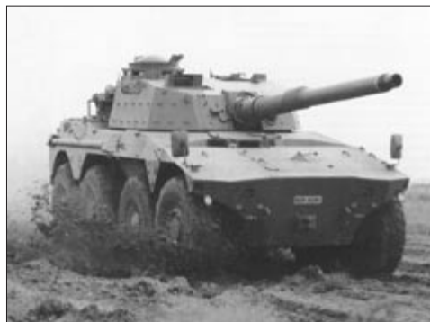
Южноафриканская БМОП «Ройкат» со 105-мм пушкой GT-7 с нарезным стволом
