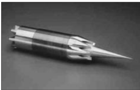
Рис. 4. Снаряд, оснащенный ГПВРД и являющийся 20 проц. моделью гиперзвуковой УР, используемый в экспериментах
