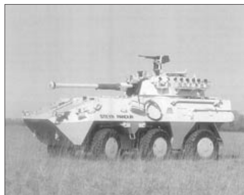
Австрийская БМОГ «Пандур-2» (6 × 6) с 90-мм гладкоствольной пушкой
