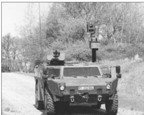
Германская БРМ «Фенек» (выдвигная мачта с аппаратурой наблюдения в боевом положении)
