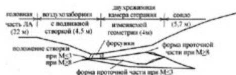
Рис. 12. Схема проточной части прототипа ПБРД WRR
